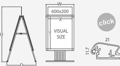
Está fabricada en aluminio por lo que es ligera y resistente a la oxidación. Tiene un perfil con sistema click de 21mm de ancho. Cuenta con un soporte de cabecera para mostrar un gráfico. Incluye protector antirreflejante resistente a la intemperie. Ideal para usar en el exterior o interior de tu tienda, restaurante, puesto callejero o supermercado.
