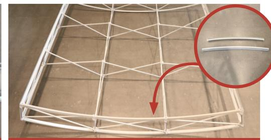
7. Coloque las barras curvas largas en la trasera (curva exterior) y las más cortas en la delantera (curva interior)
