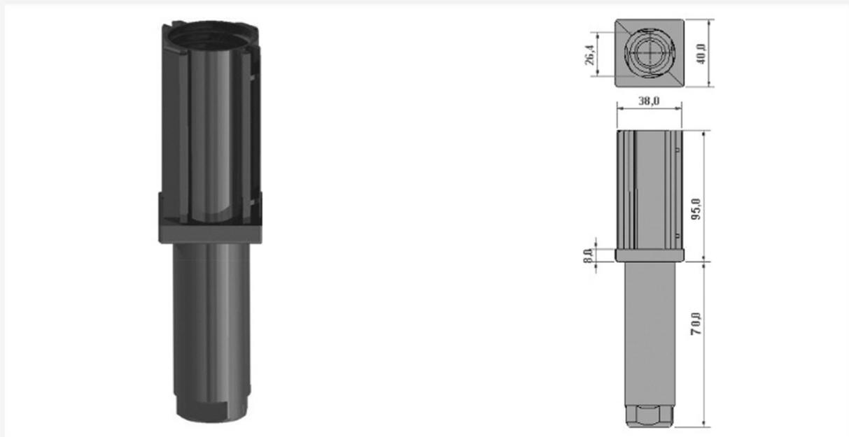
**Pata regulable de 40x40mm en poliamida con parte móvil en poliamida**
